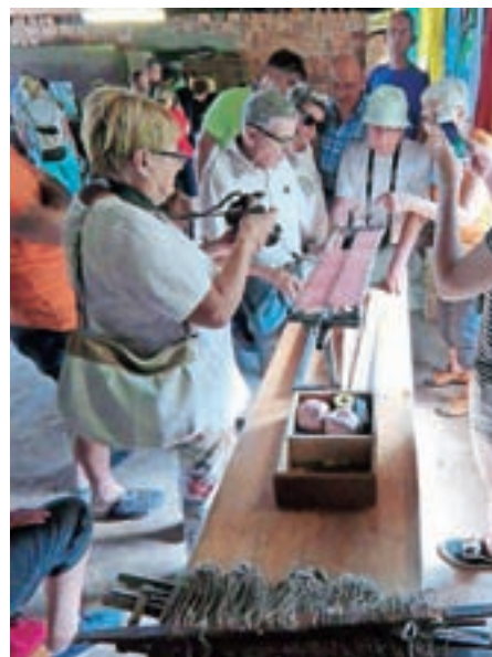
Tine Kejžar je na napravi, imenovani ničevnik, prikazal, kako se "nasnujejo" statve.
